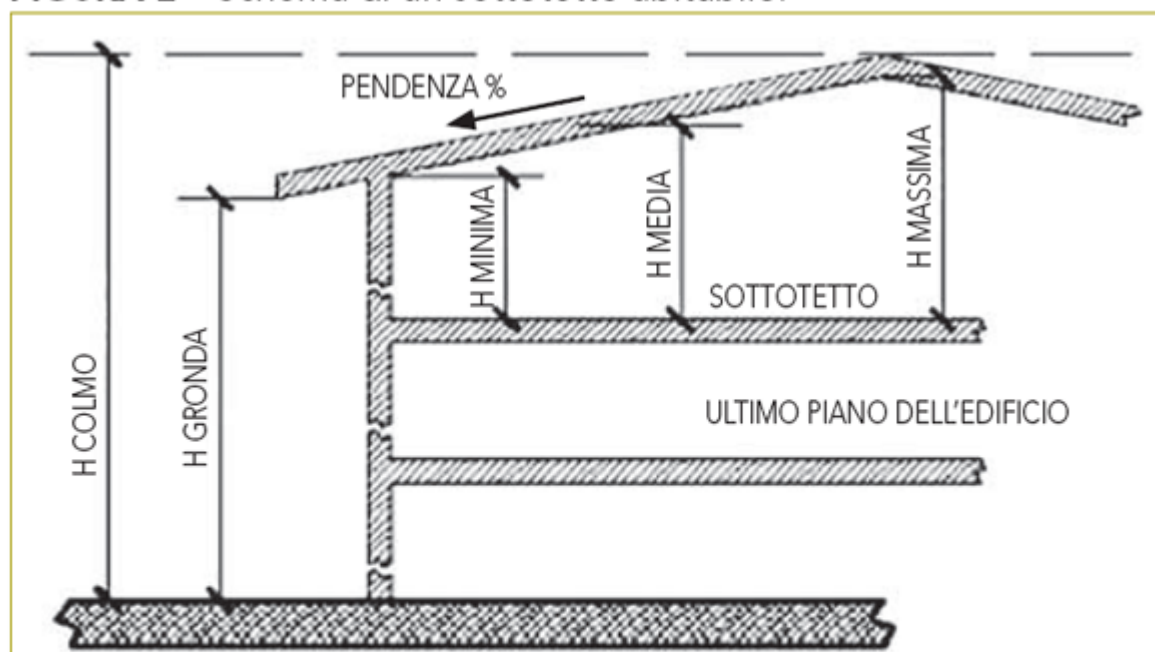
FIGURA 2 – Schema di un sottotetto abitabile.
